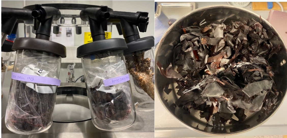
Figur 7 Biomasse overført til kolber (t.v.) som ble hengt opp på frysetørken Delta 2-24 LSCplus, og tørket biomasse (t.h.) for oppmaling med «Royal Catering Multi Grinder»
