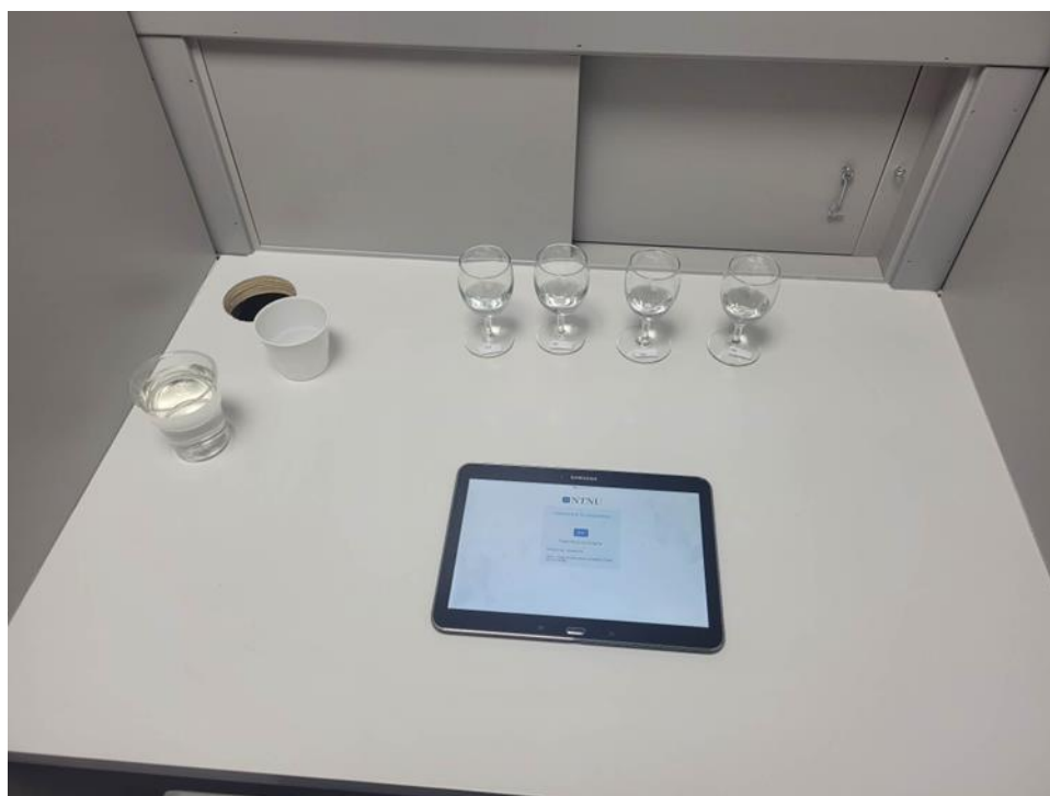
Figur 12: Oppsettet av sensorisk analyse vist i en tilfeldig bås, med vannglass, spyttkopp, de fire prøvene og nettbrettet til gjennomføring.
