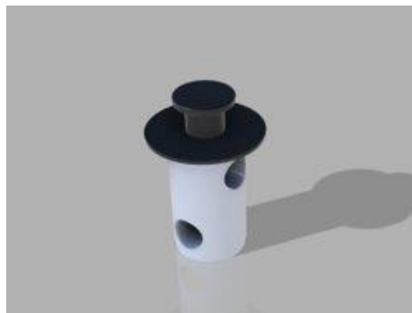
Figur 2: CAD-modell av 3-veis ventilen som styrer porsjoneringen.
