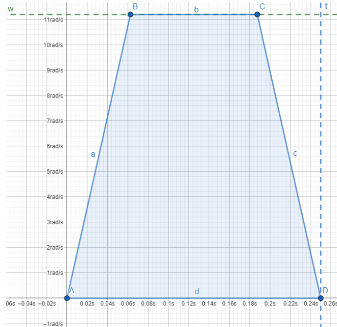
Figur B.4: Modul - Plot av vinkelhastighetsforandring som funksjon av tiden
