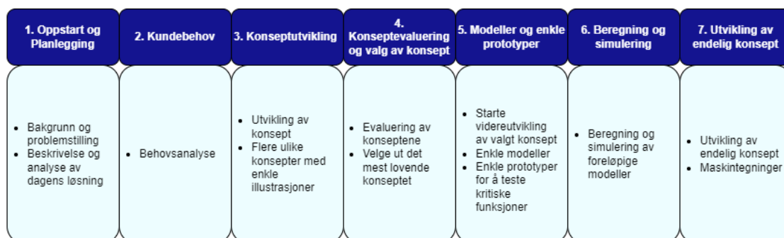
Figur 7: Produktutvikling basert på modellen til (Eppinger og Ulrich, 2016)
