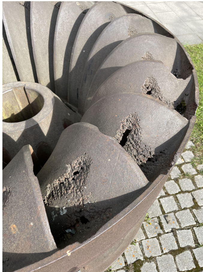
Figur 2.3: Skade på løpehjul som følge av kavitasjon. Foto:privat.
