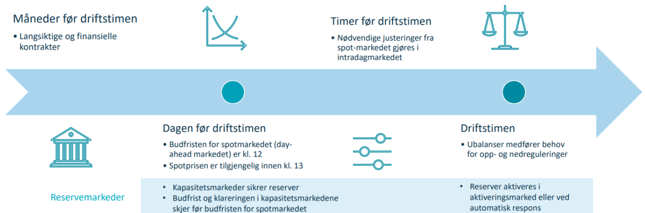
Figur 2.20: Tidslinjen beskriver når ulike aktiviteter og handler gjennomføres. Finansielle og langsiktige kontrakter skjer flere måneder eller år før driftstimen. Klarering i spotmarkedet og reservemarkedene skjer stort sett dagen før. En kan handle i intradagmarkedet nesten helt frem til driftstimen. I driftstimen forbrukes kraften som er handlet. Dersom det oppstår ubalanser, aktiveres reservene anskaffet av Statnett for å håndtere disse.[32]
