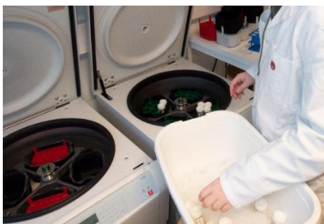
Figur 25: Etter 60 min i varmebad og 10 min i isbad ble prøverørene sentrifugert i 20 min.
