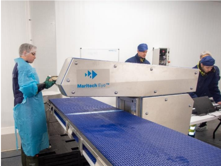
Figur 15: Torsk ble plassert på båndet og gikk under Maritech Eye for å skape hyperspektrale bilder (photovision).
