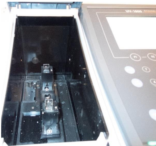
Figur 26: Spektrofotometri ved bølglengde 535 nm. Kyvetten med prøven som skulle analyseres ble plassert fremst, og baksto en kyvette med kun en blank bufferløsning som referanse.
