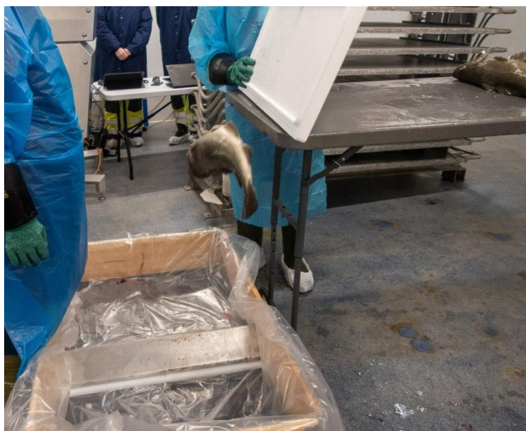
Figur 14: Torsk ble varsomt skjøvet fra benken og traff den sentrerte metallkanten i esken på gulvet.
