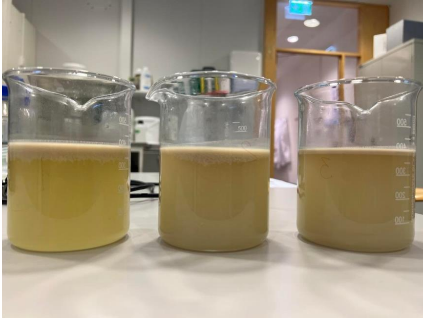
Figur 7 Fortynnet FPH behandlet ved hjelp av ultralyd ved 300W (venstre), 450W (midten) og 600W (høyre)
