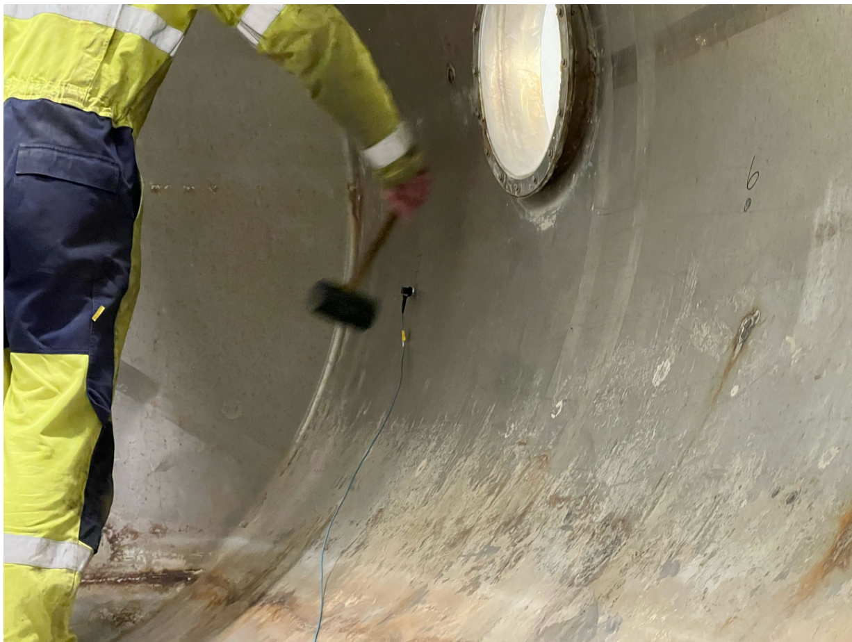
Figur 11: OMA av tanken for å finne egenfrekvenser
