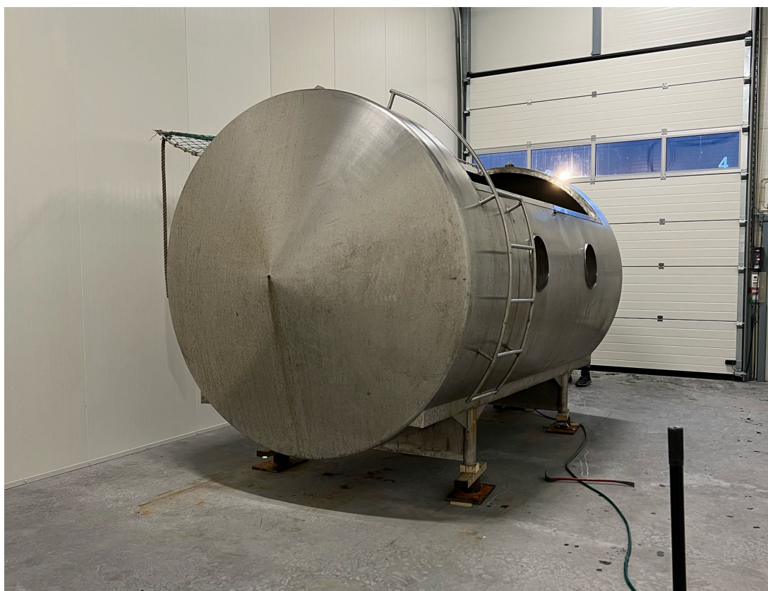
Figur 9: Testtanken, tidligere melketank konvertert til akvarium
