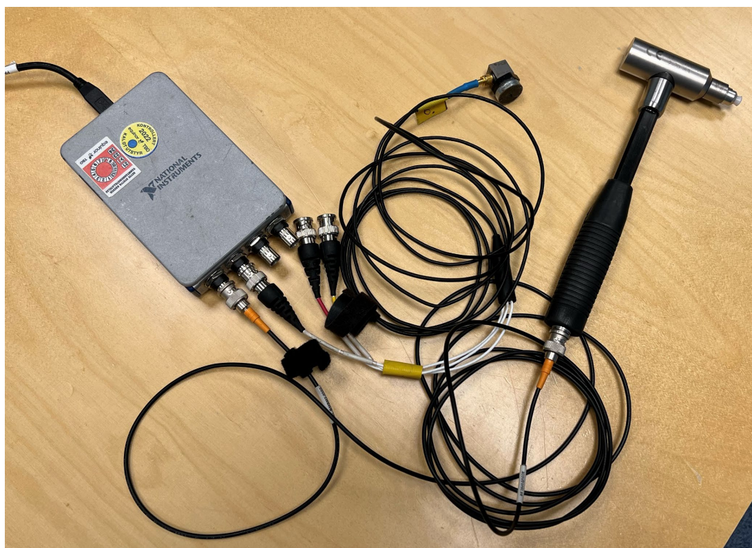
Figur 4: Akselerometer og instrumentert hammer, utstyr brukt i EMA
