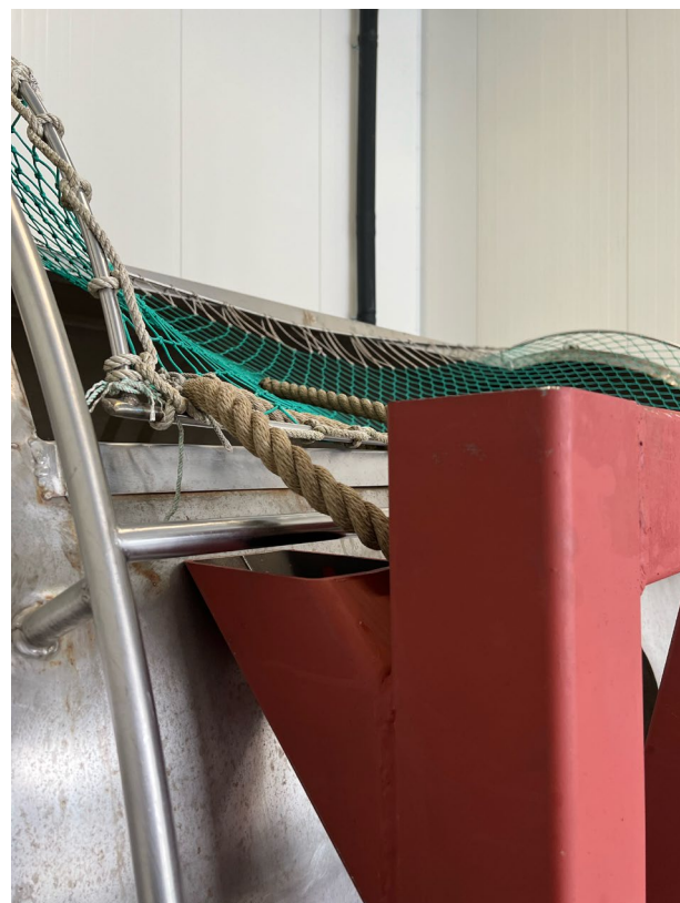
Figur 19: Fysisk ramme med for lav høydeklaring
