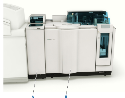
Figur 2.4: Referansemetoden ble utført på det fullautomatiserte immunologiske analyseinstrumentet Cobas 8000 e602 (50).
