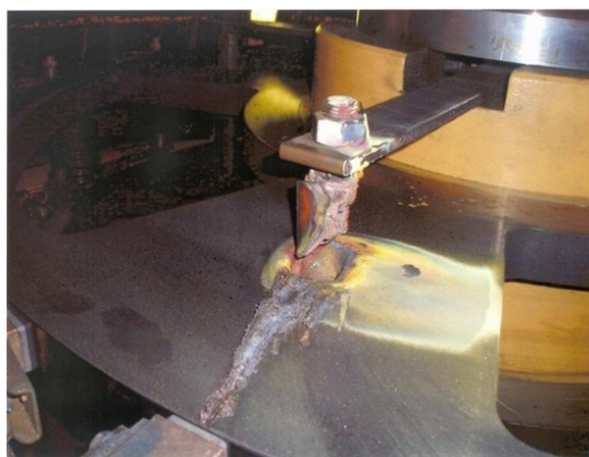
Figur 4.3.2: Kortslutning sleperinger: Anonymisert av sender.
