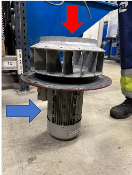
Figur 11: Sperrluftvifte oppmontert med el-motor. Blå pil viser el-motoren, mens rød pil viser impeller
