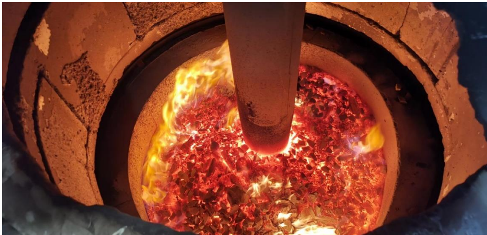
Figur 16: Innblikk i prosessen. Chargerøret vises i midten av bildet.
