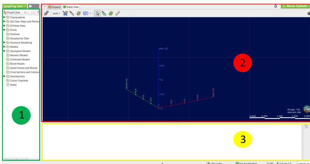
Figur 3.4: Figuren viser grensesnittet i Leapfrog. 1) Prosjekttreet, 2) visningsvinduet og 3) verktøylinje for redigering av visningsvinduet.
