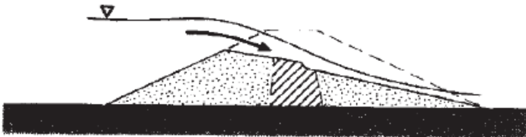
Figur 4. Overtopping av fyllingsdam (Novak et al., 2015)
