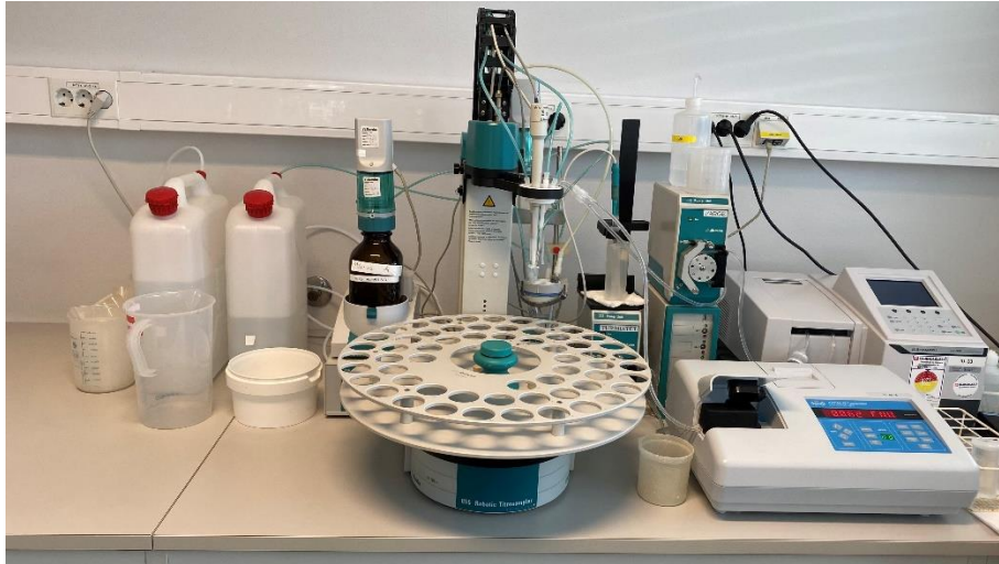
Figur 4.9 Viser pH-måler av type Tiamo analyserobot – Kilde: Bilde tatt av ansatte i Noranalyse for denne oppgaven
