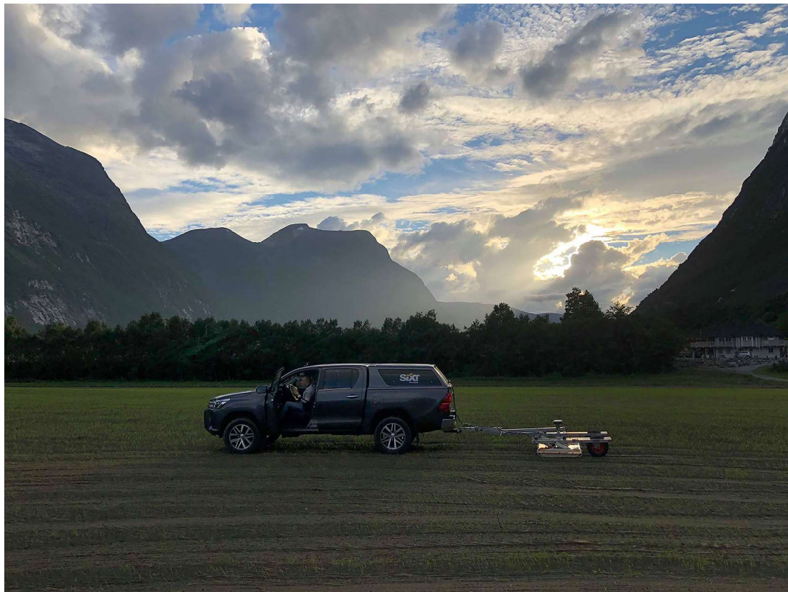
Figur 3: Bruk av georadar på pløyelagslokaliteten Løykja i Møre og Romsdal. Foto: Arne Anderson Stamnes.
