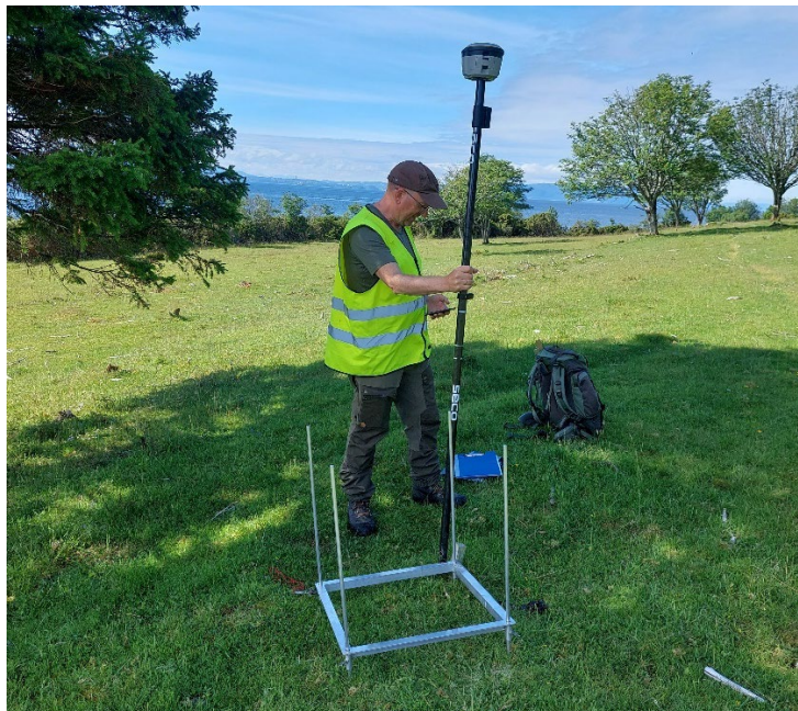
Figur 2. Registrering av koordinaten til sørvesthjørnet av ei vegetasjonsflate på Skaget med høyoppløselig GPS-antenne. Foto: A.G. Davidsen 17.06.2022.
