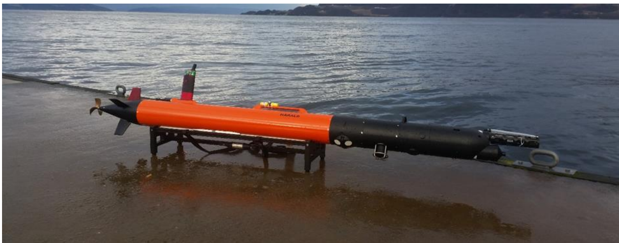
Figur 23. Det autonome undervannsfartøyet «Harald» utstyrt med telemetrimottaker og vannkvalitets-sensorer i «snuten» under testing i Gaulosen. Foto Jo Arve Alfredsen.
