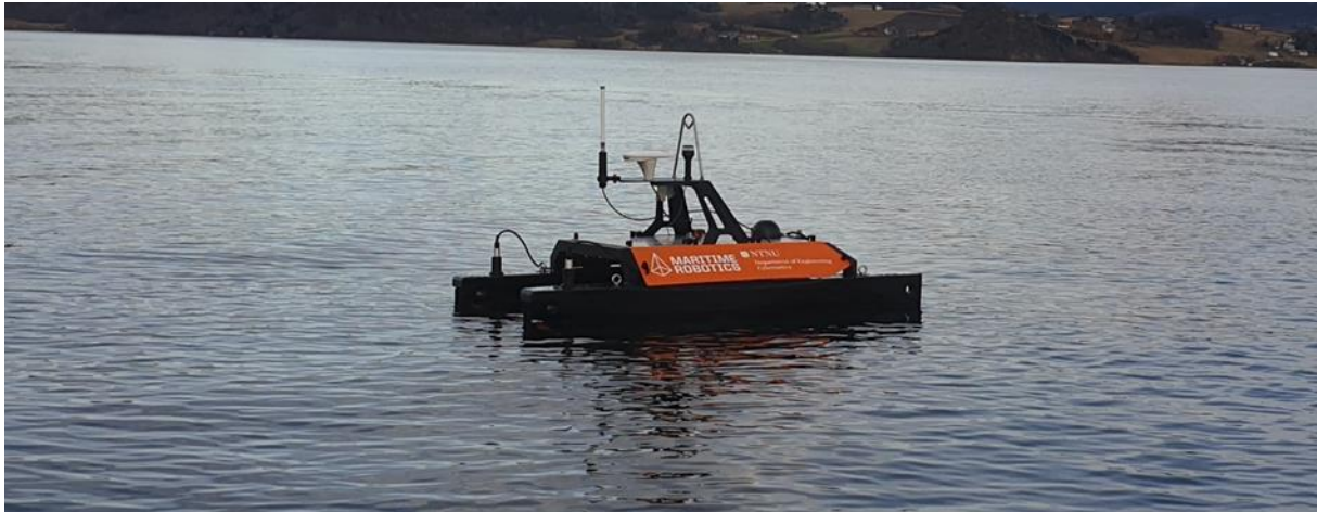
Figur 22. Robotisert katamaranfartøy utstyrt med akustisk telemetrimottaker under utprøving ved Børsa. Foto Jo Arve Alfredsen.
