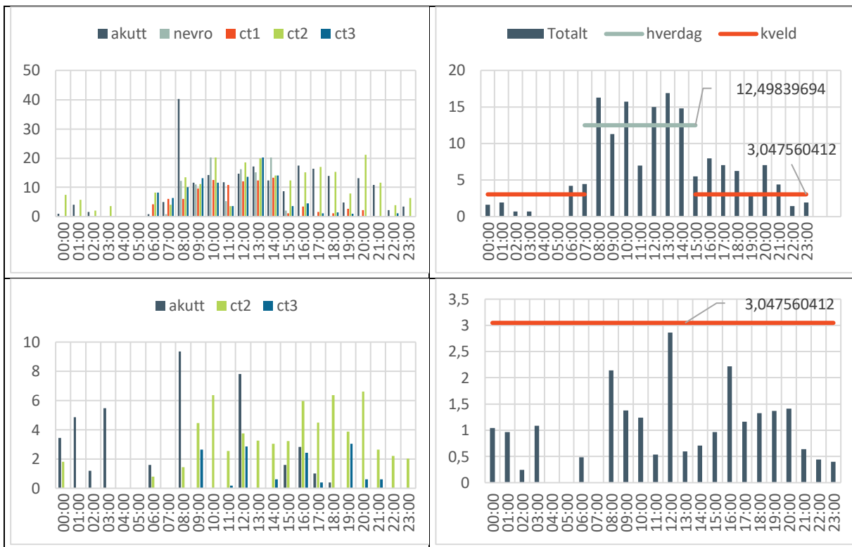
Figur 43 Sviktintensiteten som funksjon av klokkeslett. Øverst: Hverdager. Nederst: Helg Venstre: Sviktintensitet pr. maskin. Høyre: Total sviktintensitet for universell CT.
