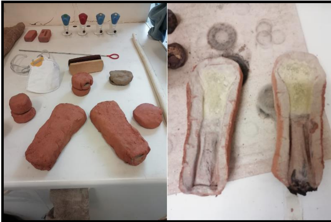
Figur 13: Leirformer før og etter bruk ved eksperimentell bronsestøyping, i undervisningssamanheng. Foto: Sara R. Langvik.
