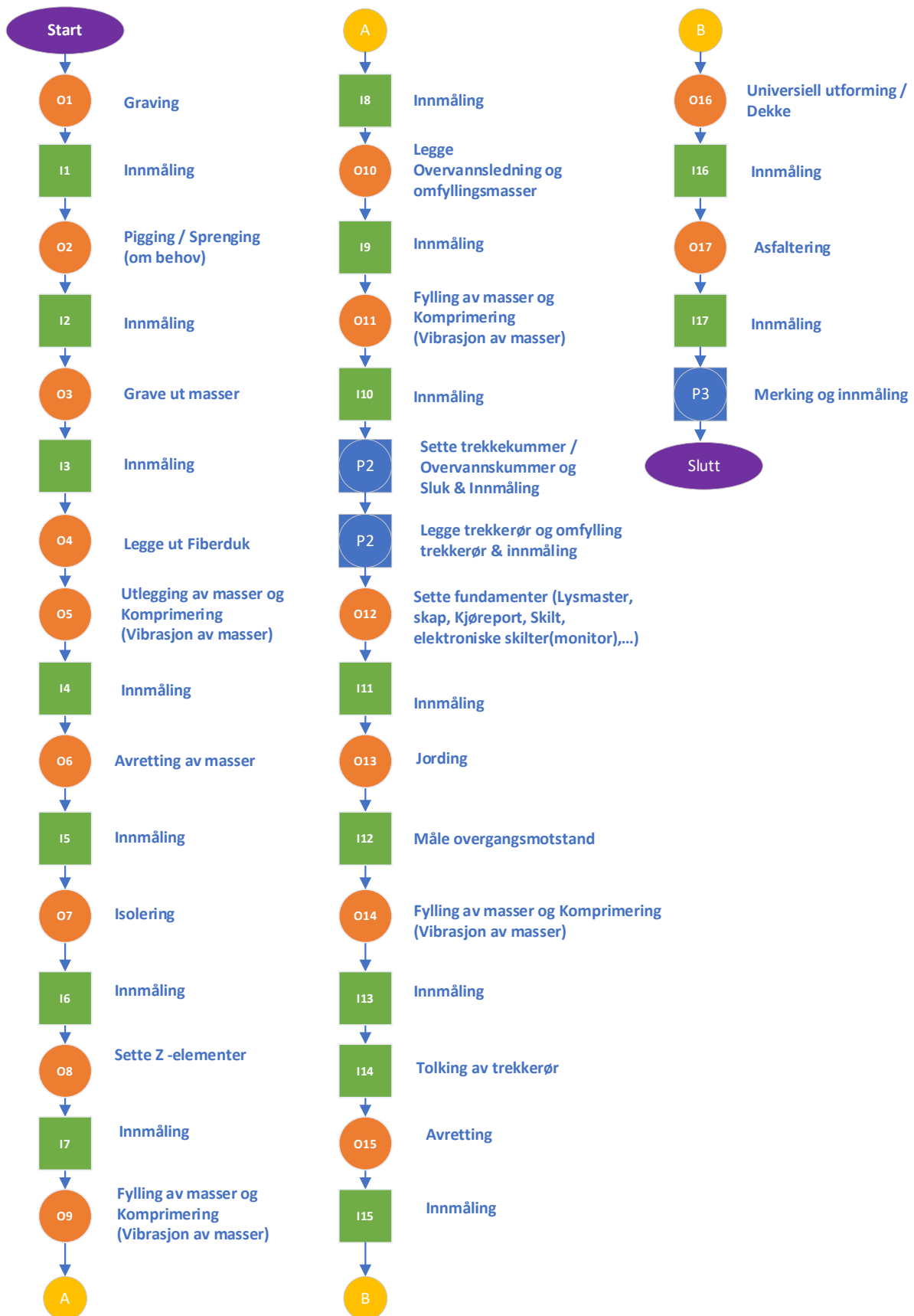
Figur 4.4: PFC (Prosessflytskjema) for bygging av plattform
