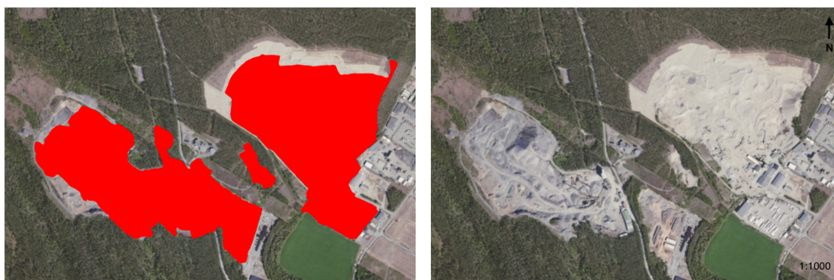
Figur 5.23: Eksempel på at datasettet arealbruk ikke er helt nøyaktig. De røde områdene i bilde til venstre representerer uttatt masse, mens bilde til høyre er ortofoto av samme område. Bildet er fra Kilemoen med vestsiden pukkverk og Kilemoen grustak.
