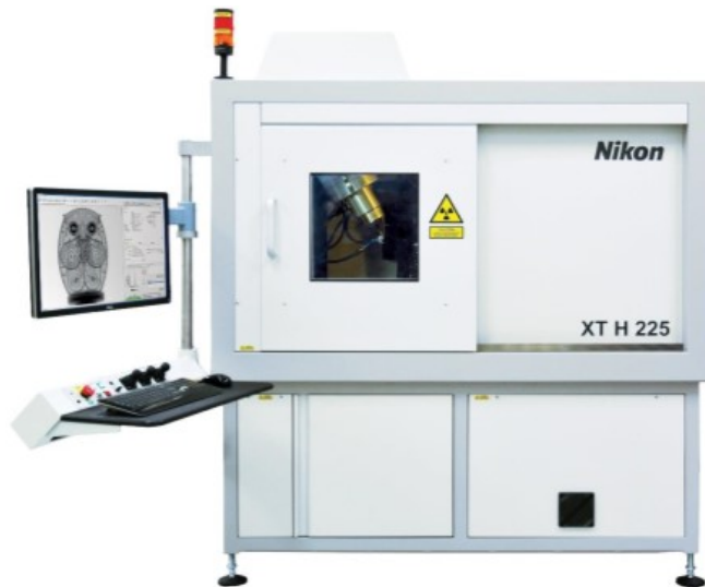
Figur 4.4: mCT-maskinen som ble brukt til å skanne prøvene (Nikon, 2022).
