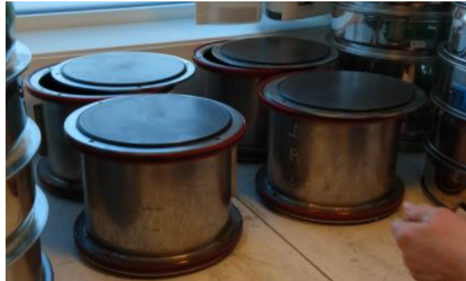
Figur 3.4 – Tromler til micro-Deval
