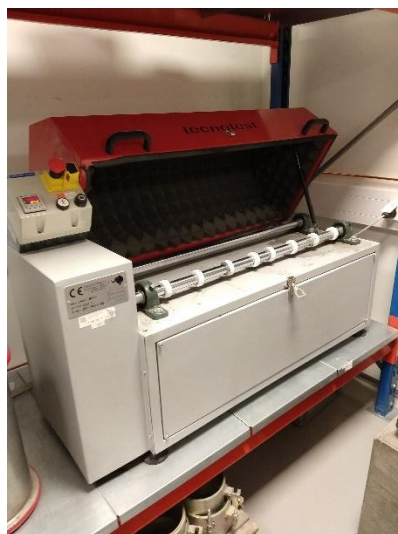
Figur 3.5 – Apparat til micro-Deval
