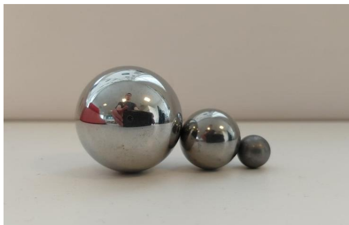
Figur 3.6 – Stålkuler til micro-Deval (Diametere fra venstre: 30, 18 og 10 mm)
