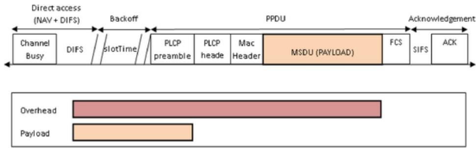
Fig. 6. IEEE 802.11 MAC overhead and actual payload.
