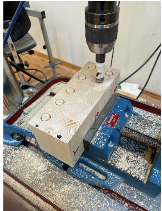
Figur 11: Utskjæring av prøvestykker med hullbor
