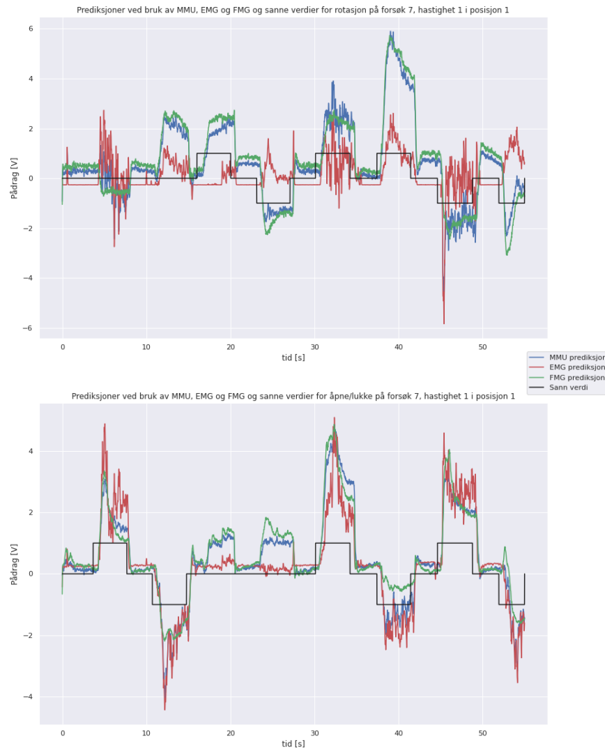
Figur 7.6: Grafen viser de sanne pådragsverdiene til begge frihetsgradene, med de korrespondende prediksjonene av hastighet 1 i forsøk 7.
