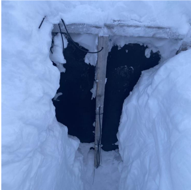
Figur 73: Bilde av hvordan temperaturmålingene i snødekket blir målt. Foto: Philip Kunz.
