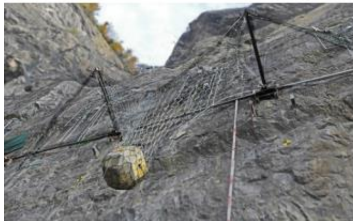
Figur 31: Bildet viser fullskala test av ringnett i henhold til europeisk standard EAD 340059-00-0106. Foto er hentet fra: (Geobrugg, u.å.).
