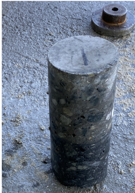
Figur 7.8: Bildet viser et eksempel på sylindervervene som ble brukt for heftforsøk på SINTEF laben.
