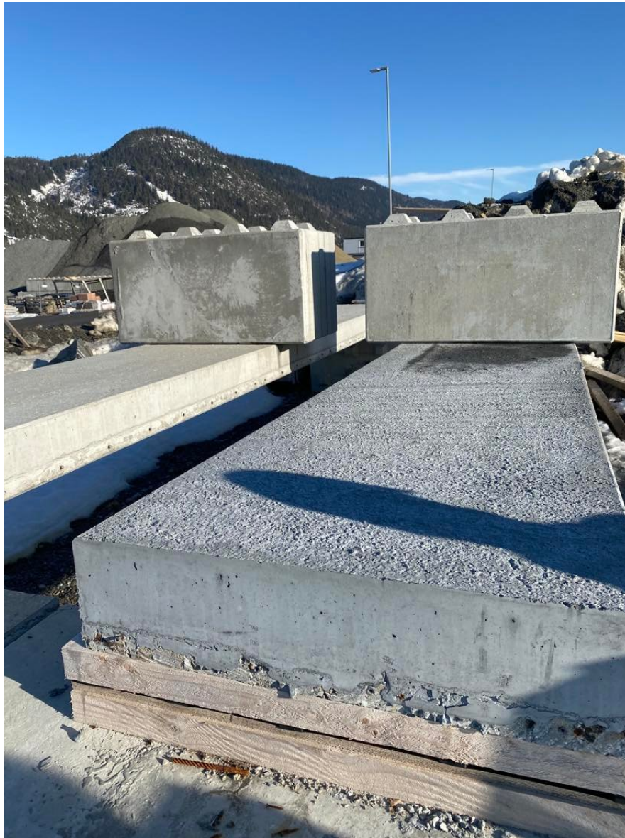
Figur 7.6: Bildet viser de fritt opplagte dekkene på Orkanger med et lodd på 2,4 tonn på midten. Dekket med Biocrete er til høyre
