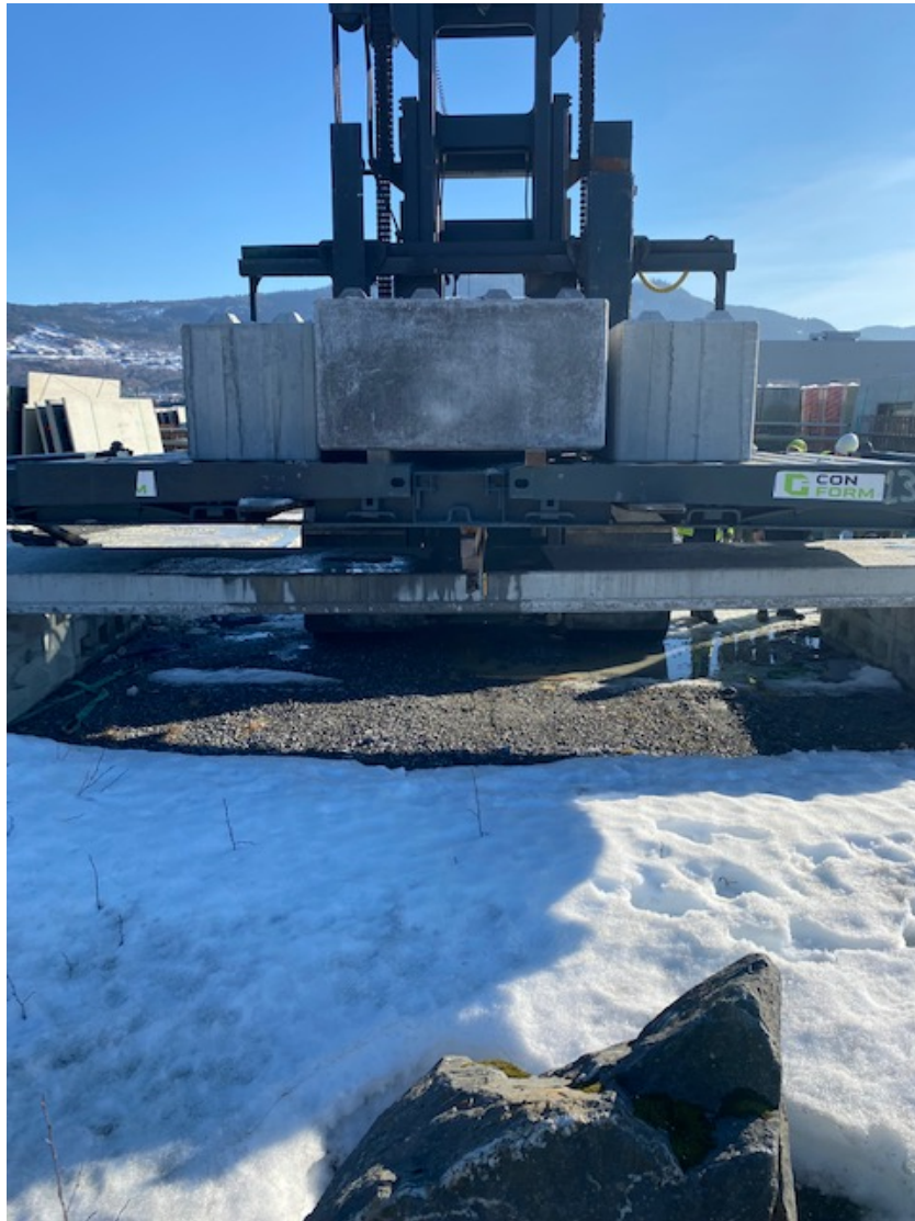
Figur 7.7: Bildet viser hvordan pålastningen til brudd ble gjennomført
