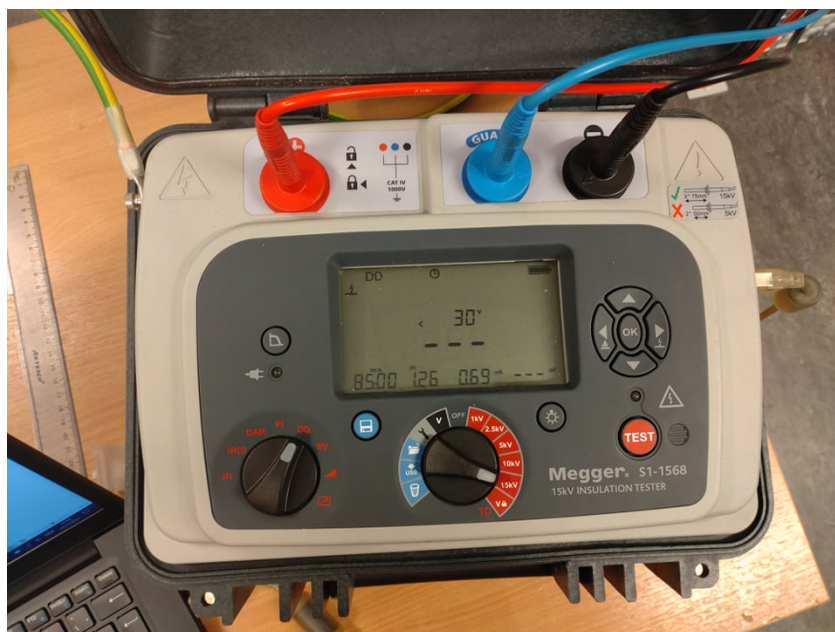
Figur 2.1: Meggeren som blir benyttet i denne studien
