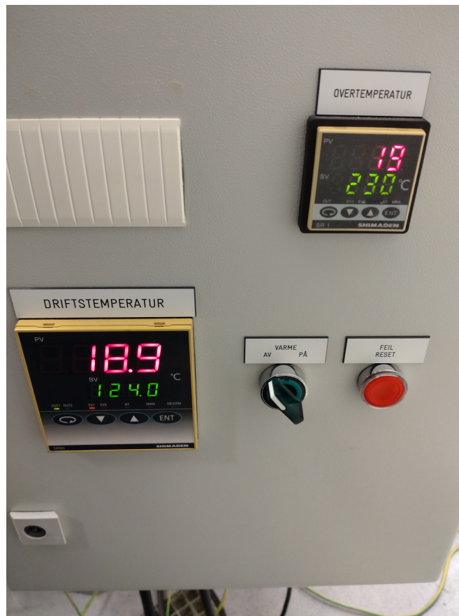
Figur .22: Styring av varmeskap
