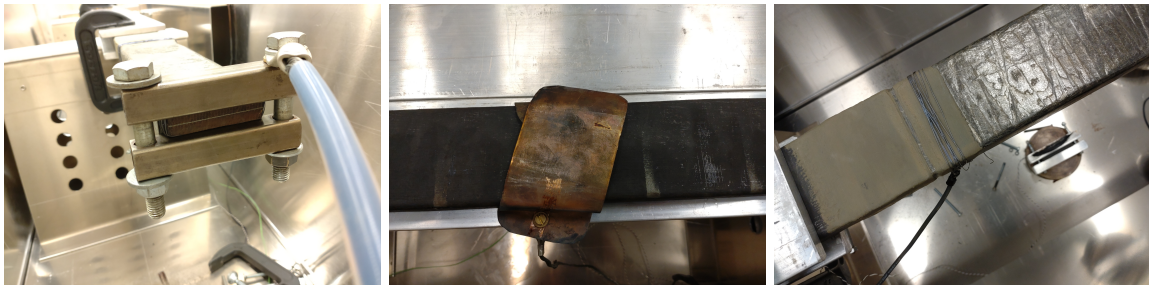
Figur .24: Koblinger inne i varmeskapet. F.V. Positiv kobling mot leder, negativ kobling mot ytrehalvleder, guard tilkobling
