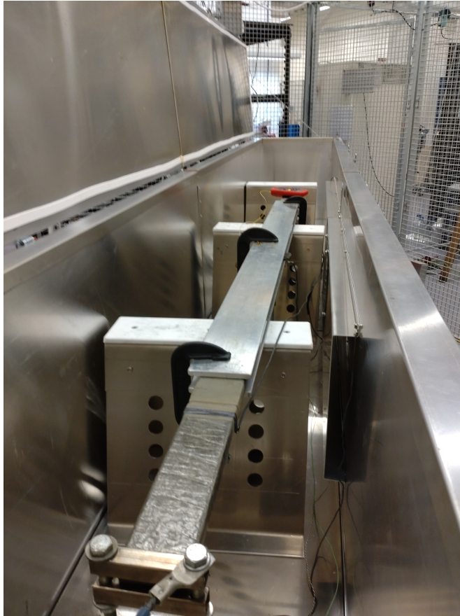
Figur .23: Innsiden av varmeskapet, generatorstav oppkoblet
