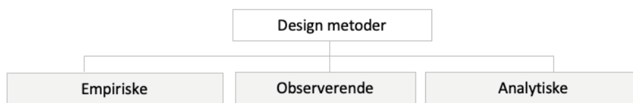
Figur 1-1: Inndeling av metoder for design av anlegg i berg. Figur utviklet basert på Bieniawski (1984).
