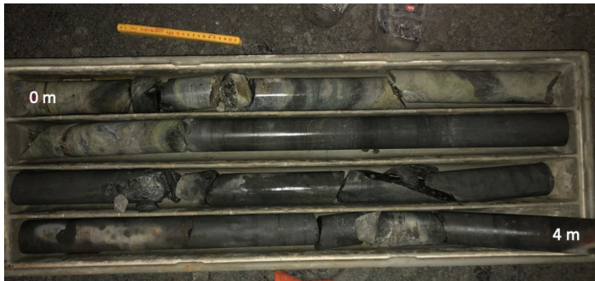
Figur 5-9: Kjerneprøver fra boring inn til prøvedyp for spenningsmåling. Bilde tatt i felt høsten 2021.
