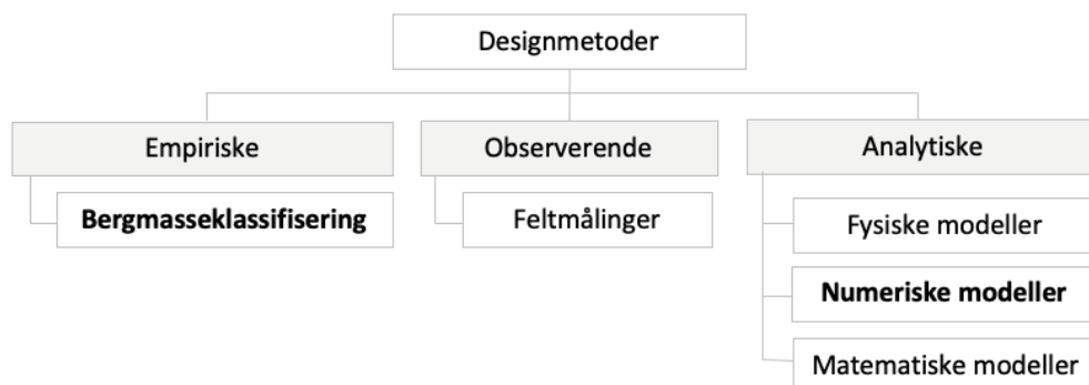
Figur 4-10: Metoder for design av anlegg i berg. Figur utviklet basert på Bieniawski (1984).
