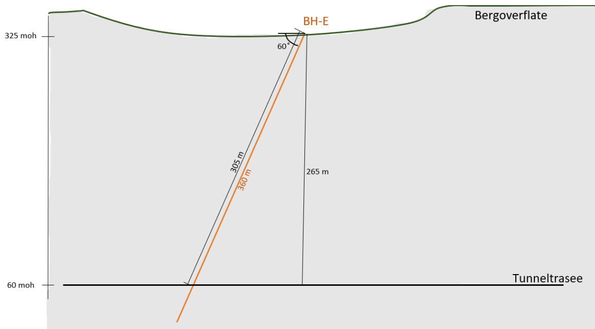
Figur 5.10. Illustrasjon over BH-E ved Seterkleiva. Hullet har et fall på 60 grader fra horisontalen.
