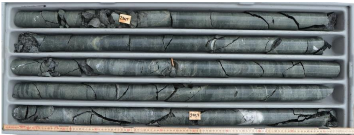
Figur 5.9. Typisk bergmasse fra BH-E, 236-241,1 m (Sweco, 2020).
