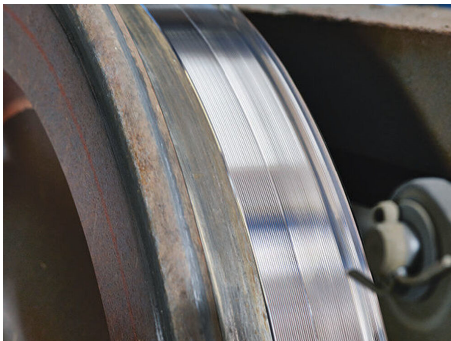
Figur 1: Reprofilering av et hjul på en hjulsatsdreiemaskin
