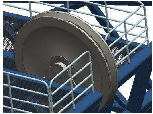
Figur 5-1 Akselbukk i toppen av testrigg
