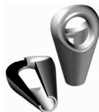
Figur 5-3 Endestykker på vaier, hentet fra www.haug.no
