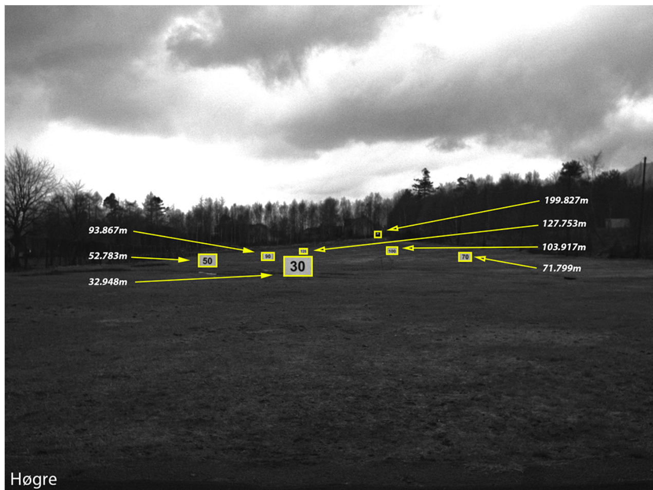
Figur 4.9: Bilde frå høgre kamera som viser plassering av og eksakt avstand til alle måleobjekt.
