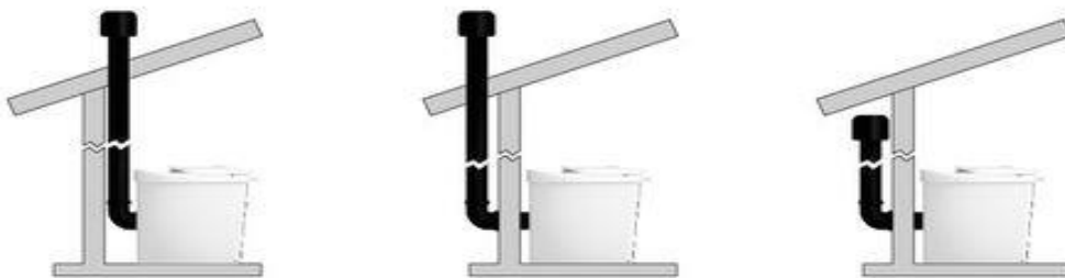
Figur 17 - Viser luftløsning for forbrenningstoiletter (25)
