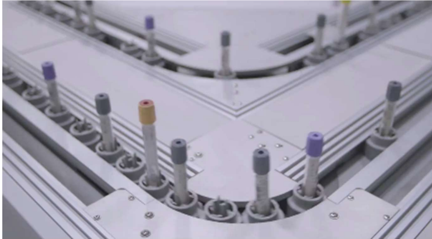
Figur 2-3 Bilde av en track på en automasjon, med prøveglass plassert i puck. (Siemens Healthineers, 2022)
