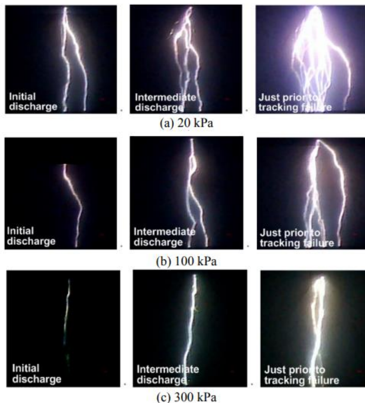
Figur 2.10: Bilde fra lysbuer som oppstår rett før gjennomslag ved variasjon i trykk mot XLPE|SIR grenseflater med påført spenning på 25 kV [20].
