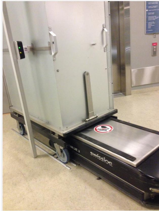
Figur 12 AGV på St. Olavs hospital (Søraa, 2021)
