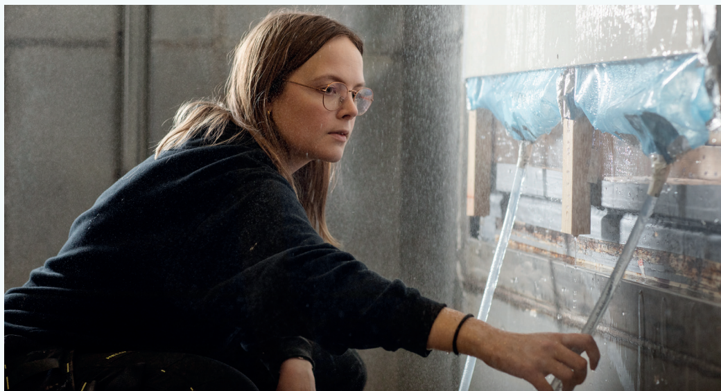
Eva Armstrong Støver kontrollerer innretningen for oppsamling av vann som renner ned på baksiden av fasadeplatene under regnforsøkene. Foto: Anne-Line Bakken.
