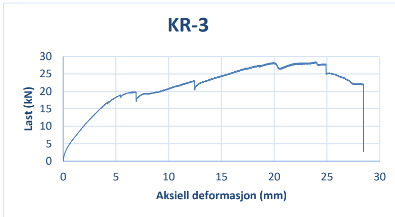
Figur 64 - KR-3 - diagram last, deformasjon
