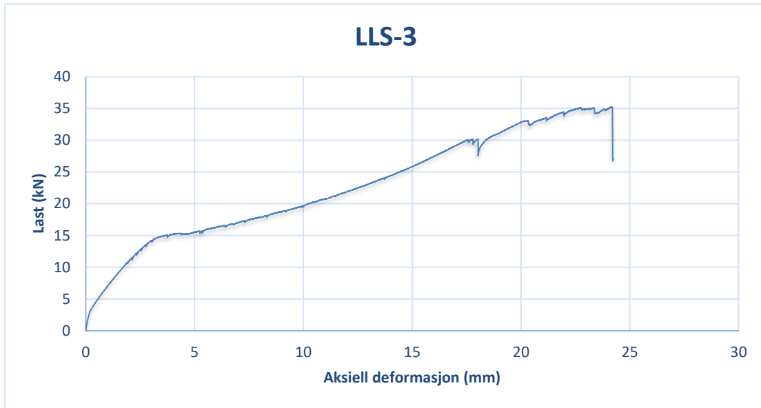
Figur 56 - LLS-3 - diagram last, deformasjon
