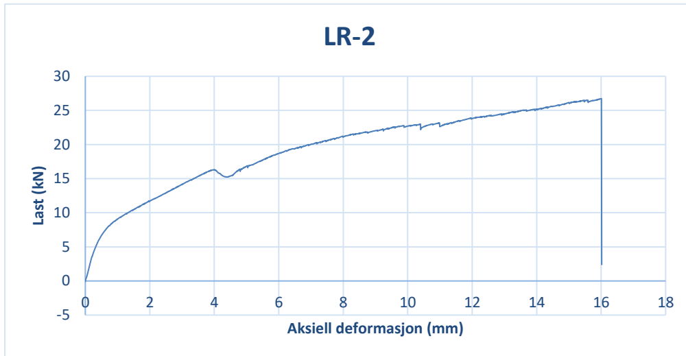
Figur 38 - LR-2 - diagram last, deformasjon
