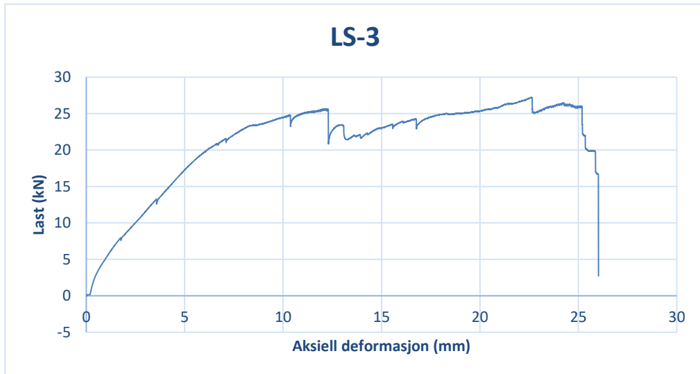
Figur 48 - LS-3 - diagram last, deformasjon
