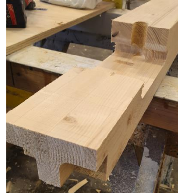
Figur 16 - Avrundingar før manuell ferdigstilling
