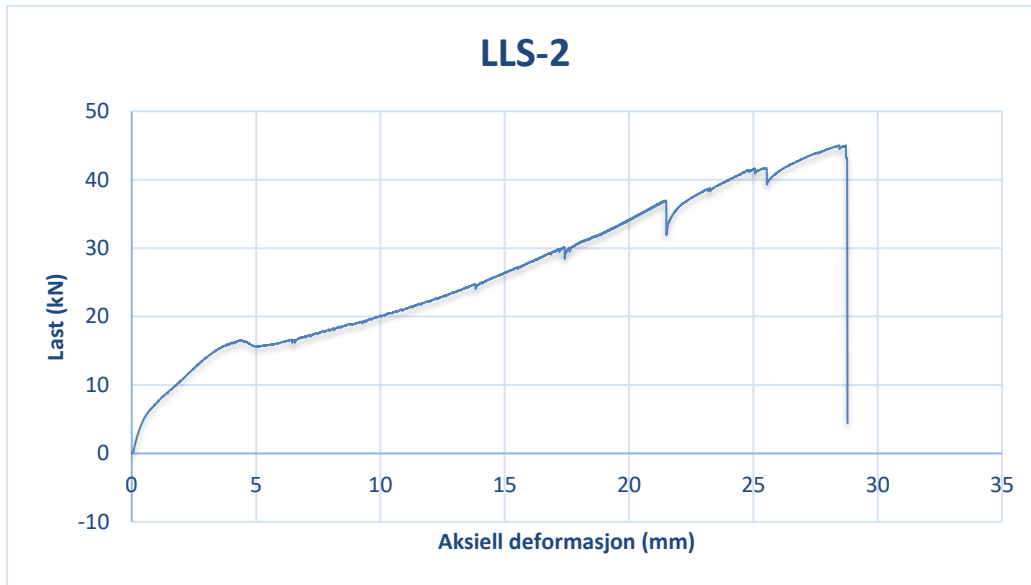
Figur 54 - LLS-2 - diagram last, deformasjon
