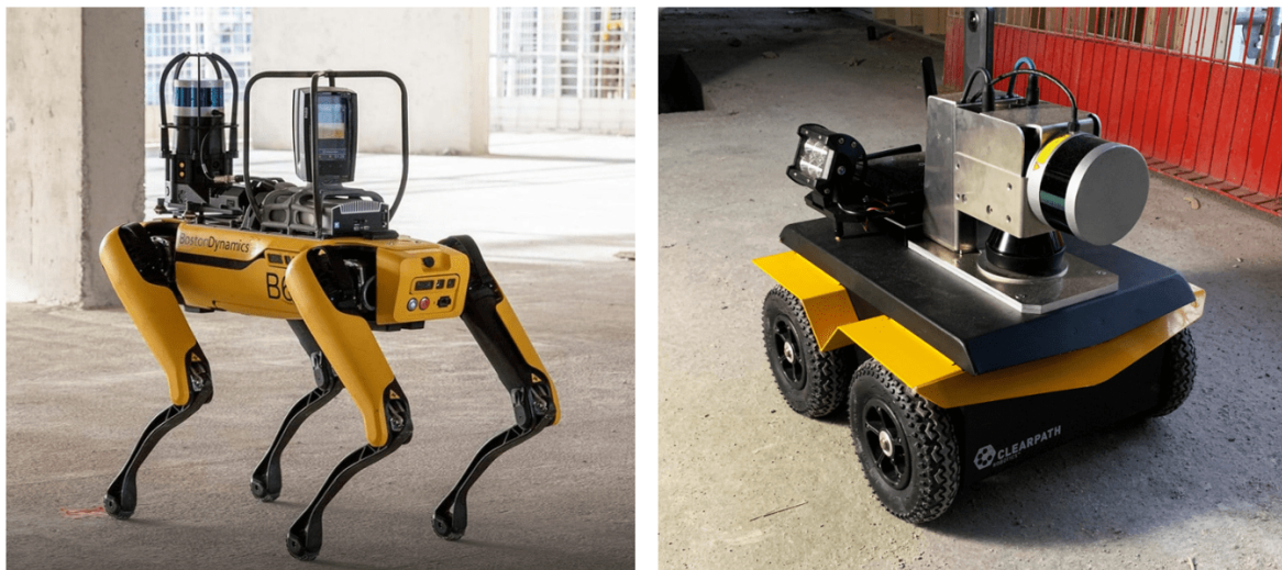
Figur 3.6: Eksempler på roboter til skanning på byggeplass, fra henholdsvis Boston Dynamics og Scaled Robotics (Cao, 2021; Frøjd, 2018).
