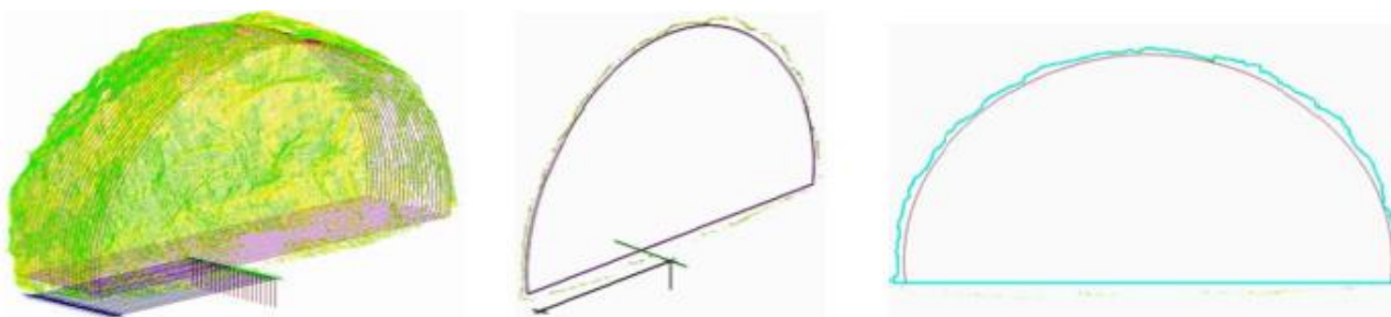
Figur 5-7: Tverrsnitt til tunnelstuff generert av punktskyer.
