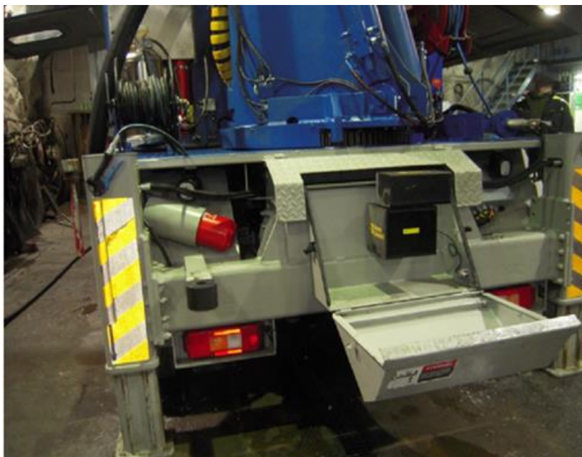
Figur 3-7: Plassering av skanneapparat på baksiden av sprøyterobot (Bever Control, 2016).
