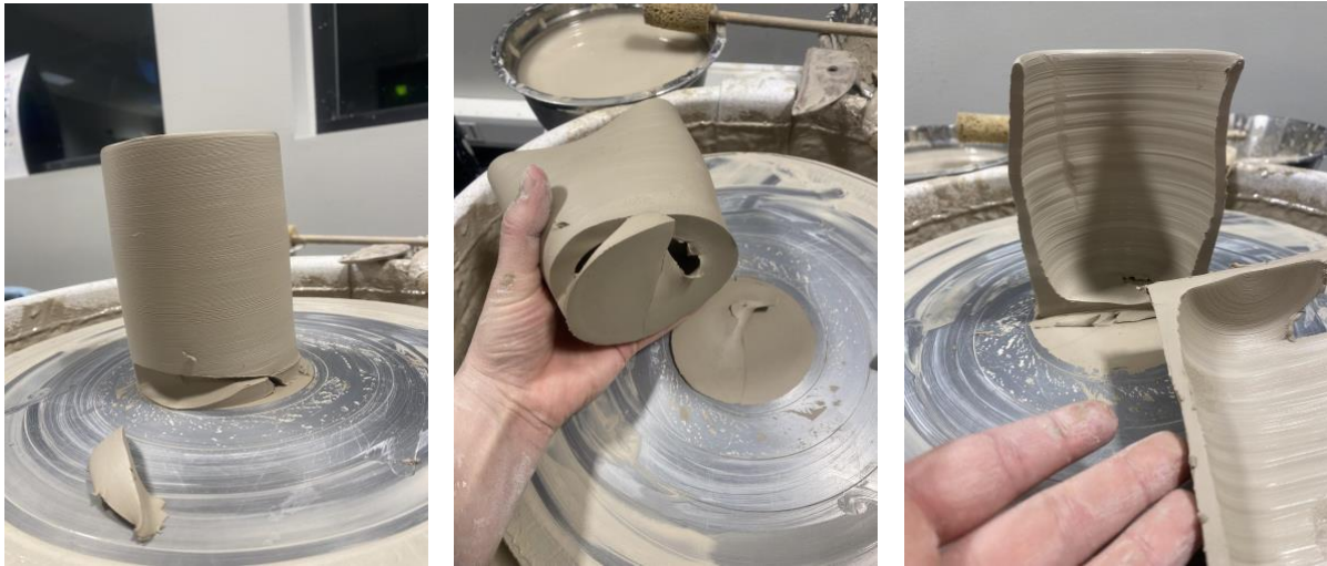
Figur 10 - Sjekke tykkelsen på veggen
