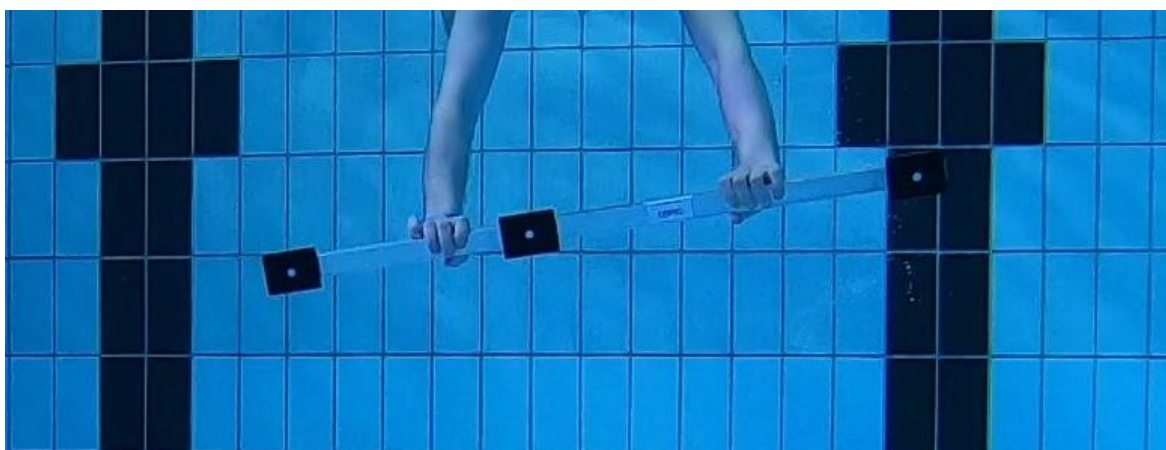
Figur 17; Måling av målestokk i vann. Målestokken og flisene i bakgrunnen oppleves helt rett. (Bilde: Privat)
