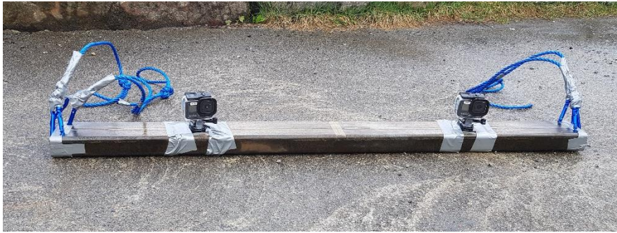
Figur 3; Ferdigkonstruert kamera-rigg med transport-tau. (Bilde: Privat)
