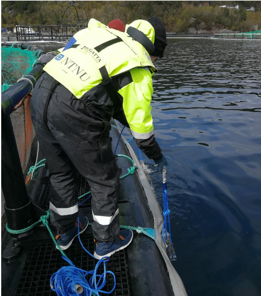
Vedlegg 7; Utsett på merd. Nedsenkning av kamerarigg for hånd (Bilde: Privat)
