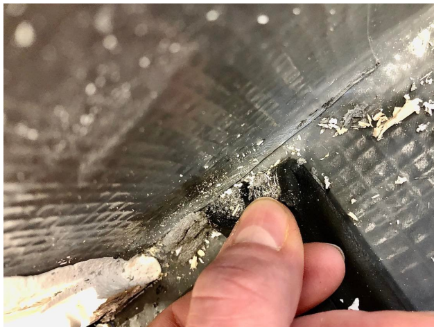
Figur 4.15: Tettelist har mistet all heft i hjørnet. Forsøk 5, andre delforsøk.
