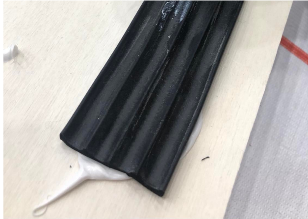
Figur 3.11: Tetteliste av neopren benyttet i Forsøk 1.
