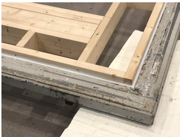
Figur 3.4: Overgang mellom tre- og stålsjableng.
