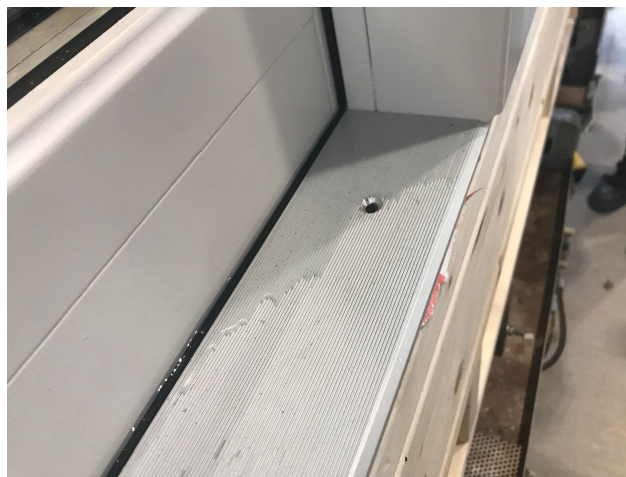
Figur 4.5: Betydelige lekkasjer i dørprodukt i Forsøk 2.
