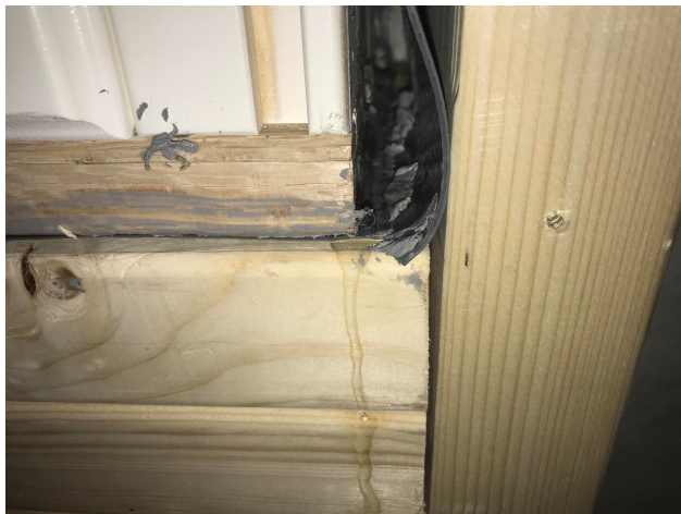
Figur 4.6: Rennende vann fra hjørne i Forsøk 2.
