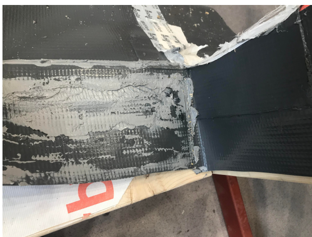
Figur 4.7: Fugemasse har blitt komprimert og dratt utover i Forsøk 2.
