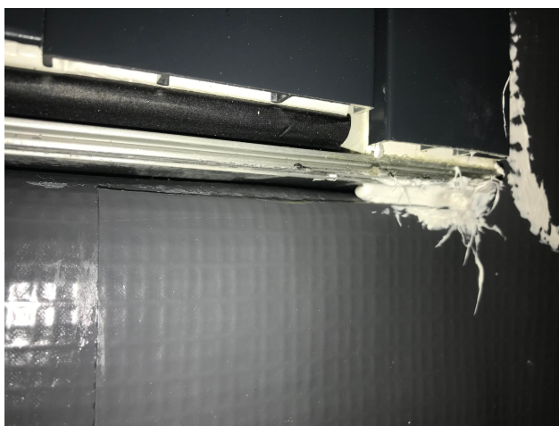
Figur 3.29: Forsøk på å forbinde fugemasse og tettelist i Forsøk 4.
