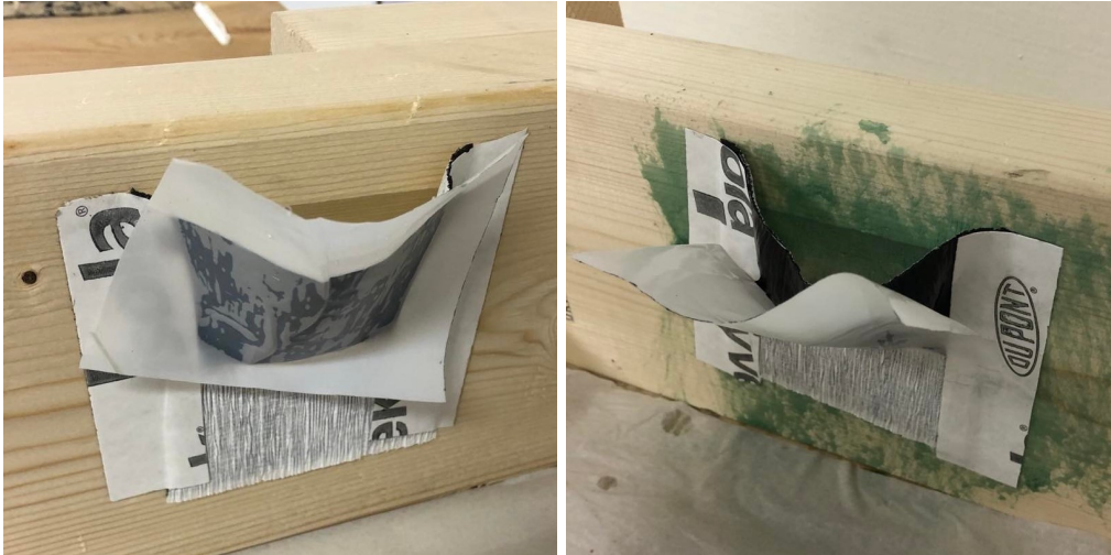
Figur 3.34: Oppsett for å teste heft mellom FlexTett og konstruksjonsvirke uten primer, som vist til venstre, og med primer, som vist til høyre på figuren.
