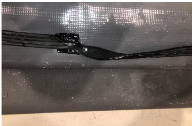
Figur 4.3: Tettelist vrent utover omtrent ved midten av terskel i Forsøk 1.
