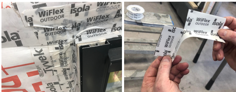
Figur 3.18: Tilklippet tapebit, vist til høyre, brukt til å forsterke hjørner i Forsøk 2.
