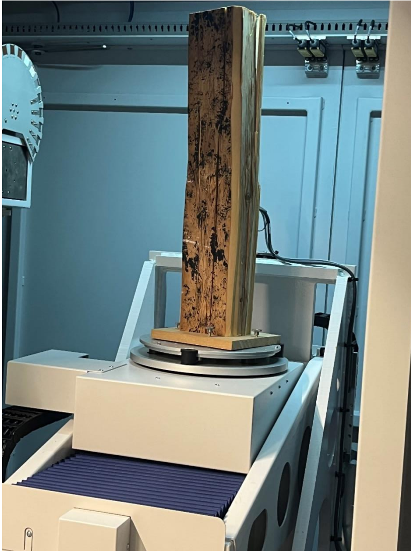
Figur 23: CT- Skanning gjort på lab NTNU, Gjøvik. (Foto: Privat)
