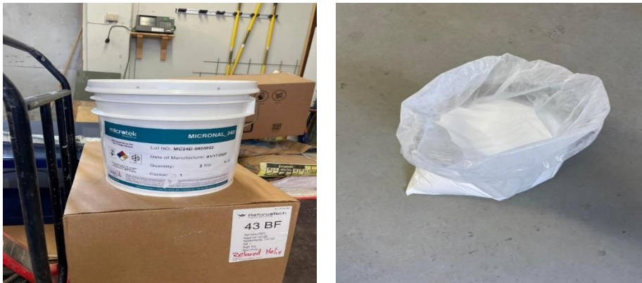
Figur 9-PCM-pulver brukt i mørtelblanding. Foto: Marwan Heri
