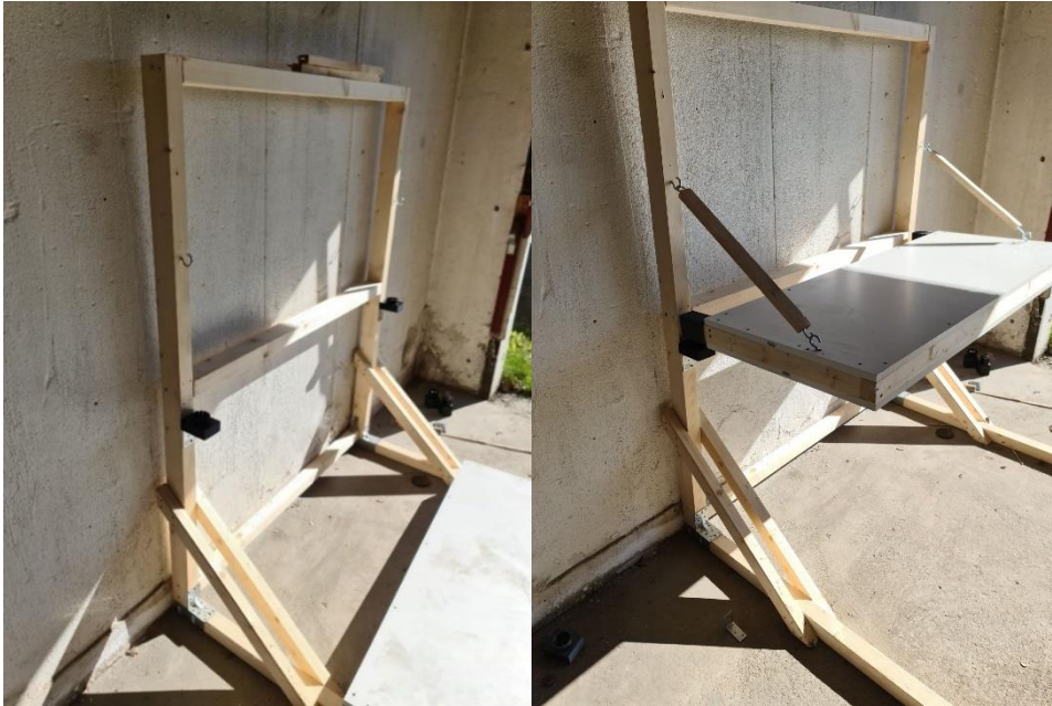
Figur 89: Test-rigg med kuleholder på søyle til venstre, og ferdig montert til høyre.
