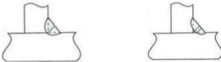
Figur 78: Utførelse av sveis. God gjennombrenning til venstre. Manglende gjennombrenning til høyre (AWI, 2014).
