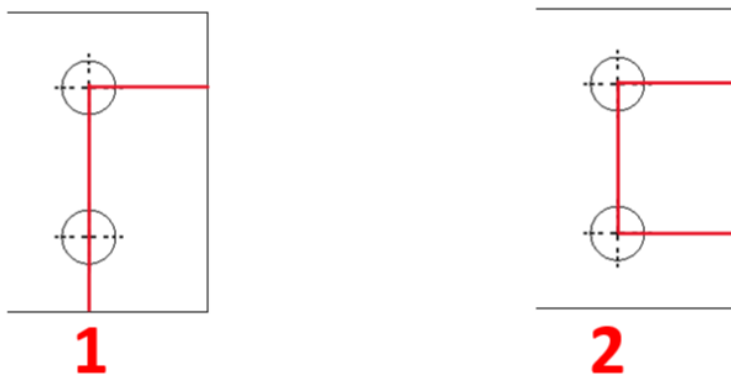
Figur 39: Relevante bruddformer for knuteplate som må kontrolleres iht. AISC.
