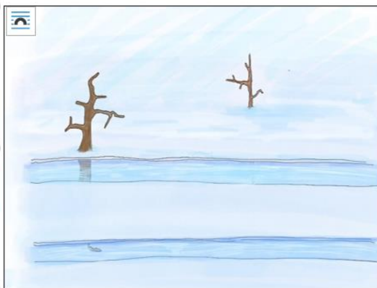
Figur 3-3: Illustrasjon av glatte spor etter brøytesko uten isriverskjær
