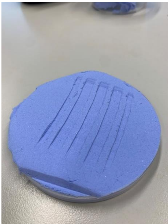
Figur 6-2 Spor etter 3D.printet, perforert isriverskjær
