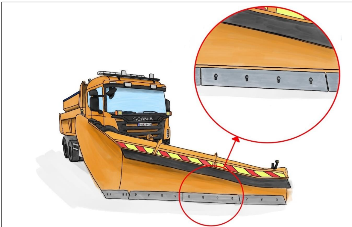
Figur 4-7 : Lastebil med plog påmontert brøytestkjær. Denne type plog benyttes ikke av Steinkjer kommune ved brøyting av fortau.
