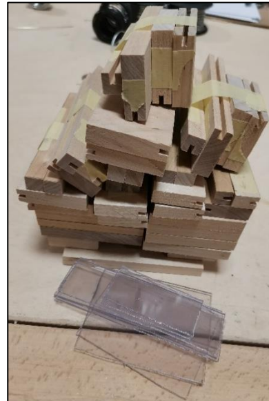
Bilde 4.26 – Alle modulene samlet før liming
