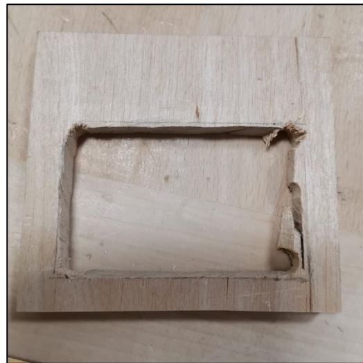
Bilde 4.24 – De tynne bitene knakk med fibrene
