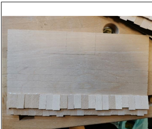
Bilde 4.14 – Linjer brukt som referansem metode for påliming av takspont
