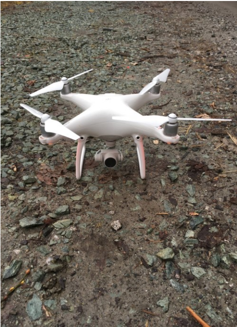
Figur 4.2: Denne dronen ble benyttet til å fotografere oversiktsbilder og høytliggende løsneområder. Foto av Edvard Ellingsrud.
