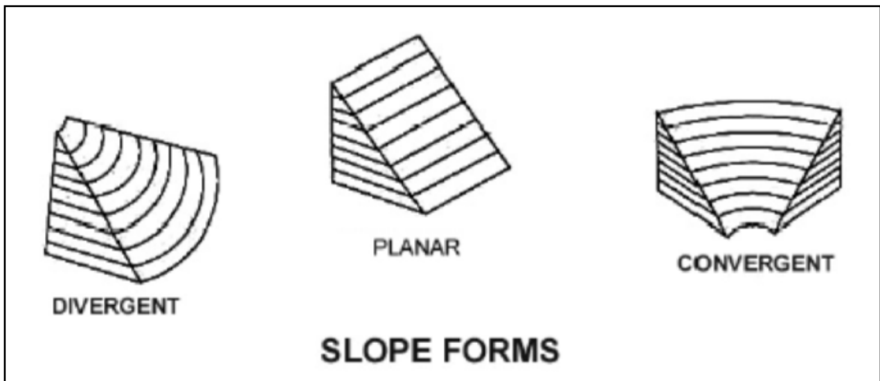
Figur 3.2: Konveks, rettlinjert og konkav skråningsform. Figur hentet fra Miller (2018).
